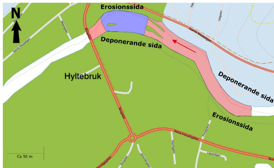
Figur 18. Visar erosionsförhållandena för Nissan.
