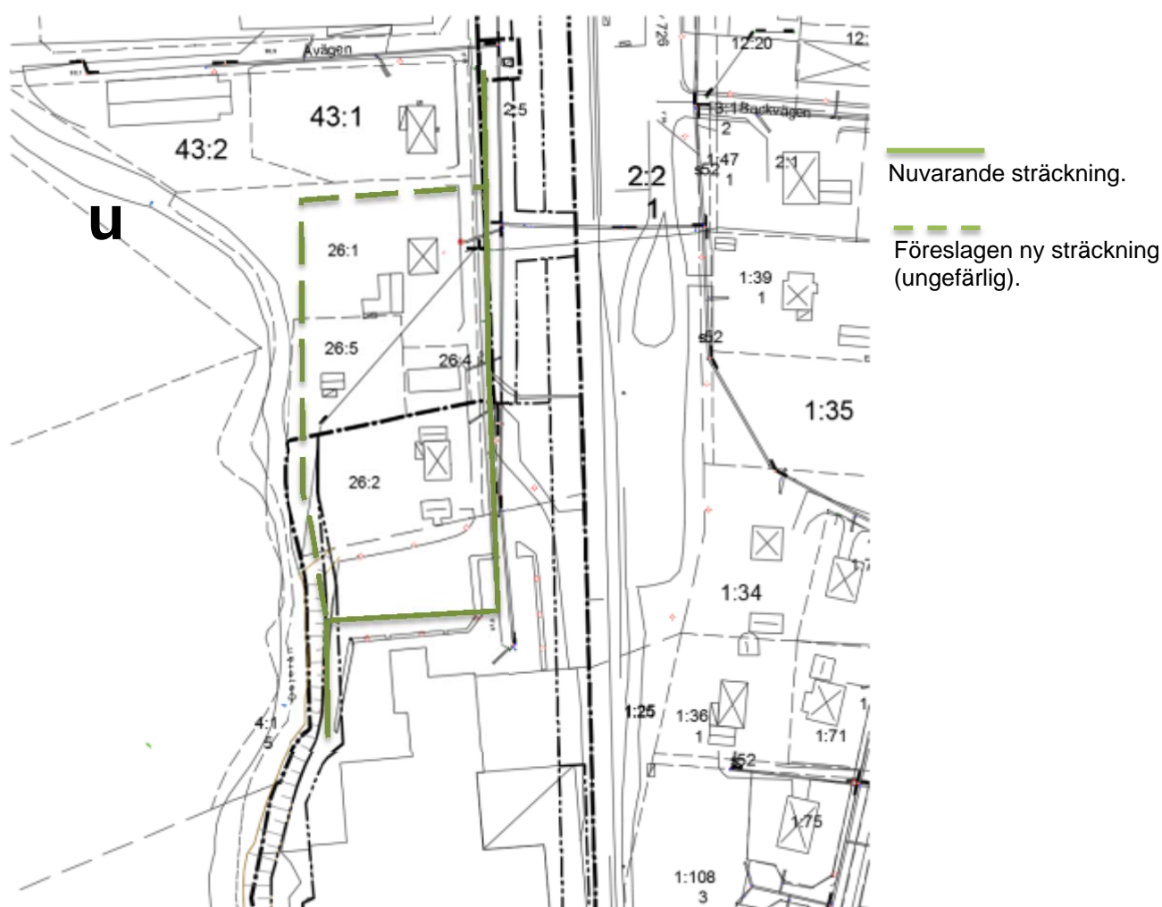
Figur 6. Befintlig högspänningskabel samt föreslagen ny sträckning vid en eventuell framtida flytt av elkabeln, i samband med planerad tillbyggnad.
